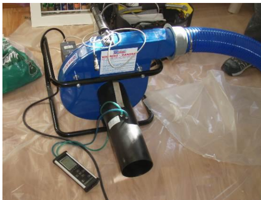
Bild 3. Provstryckningsfläkt med slang och mätenhet med tryckuttag.
